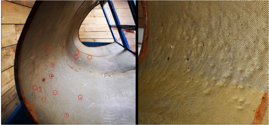
Figura N° 2: "Impactos de proyectiles disparados en pruebas de armamento".
