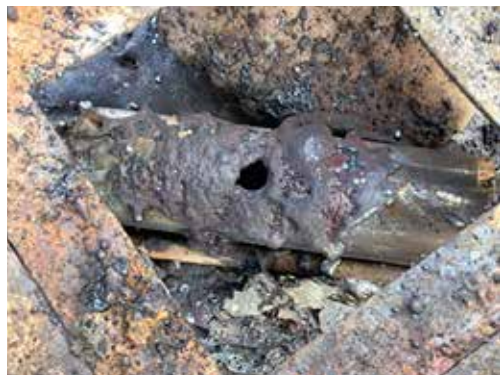
Figura N° 53: "Daño causado a la UXO simulada".
