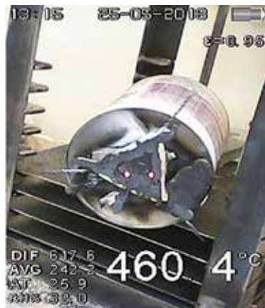
Figura N° 37: "Temperatura del crisol con aislante normal, luego de ocurrida la reacción". Fuente: archivo del autor.
