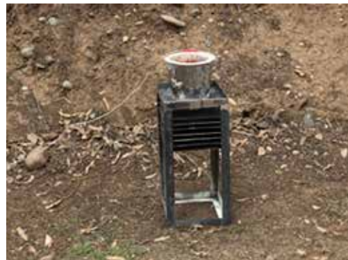
Figura N° 47: "Crisol con el sistema de ignición instalado".
