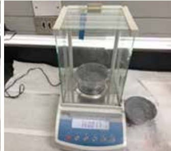
Figura N° 27: “Masado de polvo de aluminio”.
