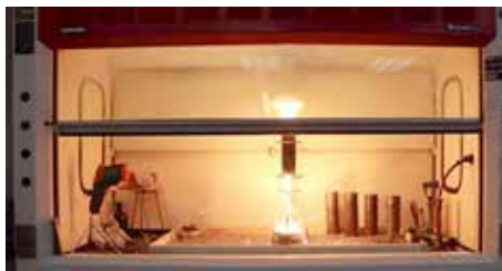
Figura N° 29: “Perforación de la probeta en su base y medición de temperatura”.
