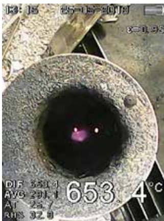
Figura N° 36: "Temperatura dentro del crisol con aislante refractario, luego de ocurrida la reacción". Fuente: archivo del autor.
