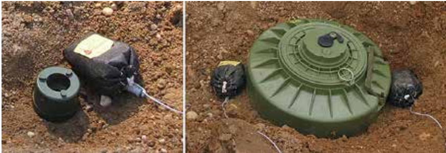
Figura N° 7: “ Pyropak usada contra T-AB-1 mina antipersonal (izquierda) y mina TMRP-6 antitanque (derecha)”.
