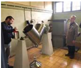
Figura N° 41: "Introducción de elementos reactivos en el mezclador".
