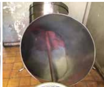
Figura N° 42: "Óxido de hierro III y aluminio en el mezclador".
