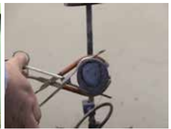
Figura N° 25: "Deslaminaciones sufridas por la probeta".
