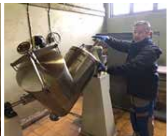
Figura N° 43: "Inicio del proceso de homogenizado mediante rotación automática del mezclador".
