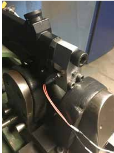
Figura N° 3: "Posición celda de carga en placa posterior".
