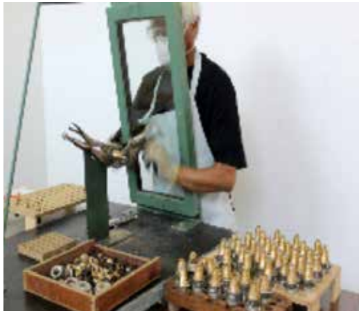
Figura N° 4: Desarme de espoletas de morteros.
