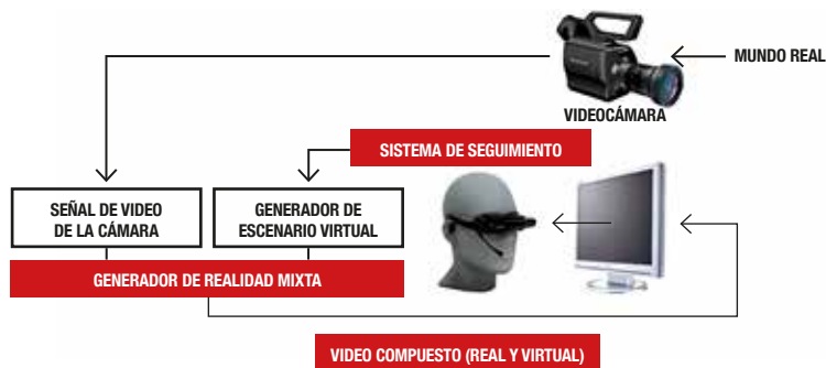
Figura N° 2: Diagrama conceptual de un sistema de realidad aumentada 4 .
