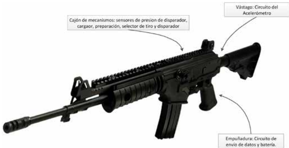
Figura N° 8: Indicación de lugares físicos de los circuitos impresos ( Printed Circuit Board, PCB ).
