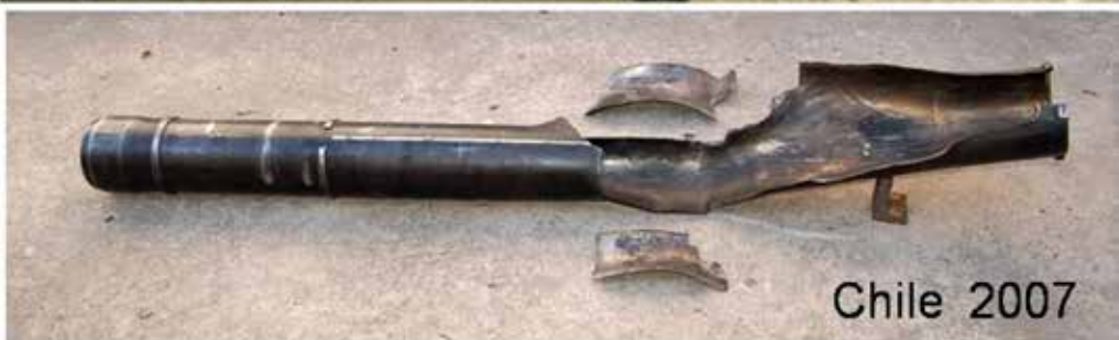
Figura N° 13: Daños presentados por los tubos de tres morteros 120 mm peritados por IDIC. Los tubos presentan daños generales similares entre sí y también con aquellos del tubo del accidente de Finlandia del año 2005 (ver Figura 12). Estos daños son consistentes con accidentes por doble carga con solo deflagración de cargas de proyección.
