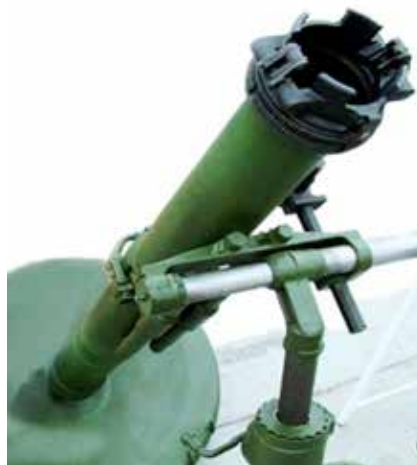
Figura N° 10: Dispositivo de seguridad instalado en la boca de un mortero para evitar la carga de una segunda bomba en el tubo.
