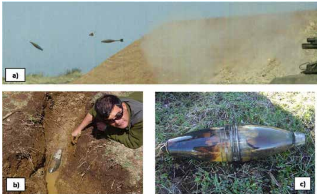
Figura N° 9: Evidencia del vuelo de bombas disparadas bajo condición de DC.: a) Vuelo errático de dos bombas lanzadas horizontalmente en DC desde un tubo reforzado para pruebas (© Centro de Ensayos de Torregorda, Cádiz, España). b) y c) Granada correspondiente a tiro corto y sordo, encontrada enterrada a más de un metro de profundidad con pérdida del empenaje y parte de su espoleta, Chile, 2004.
