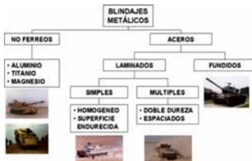
Figura N° 2: Clasificación de los blindajes metálicos.
