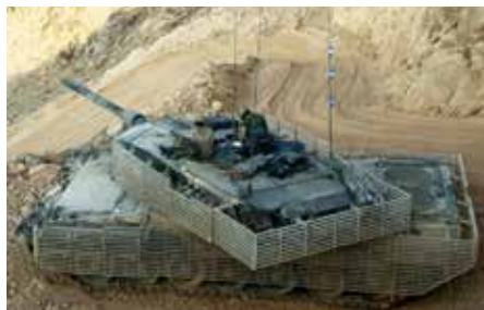
Figura N° 7: Tanque Leopard 2A4 con sistema de protección slat.
