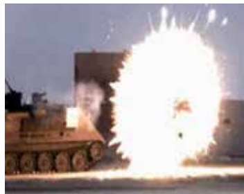
Figura N° 17: Sistema de protección activa del tipo Hard Kill.
