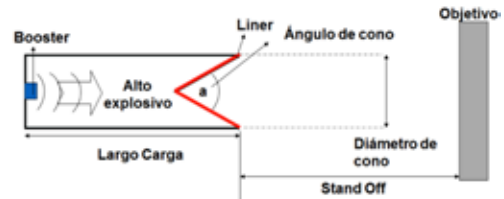
Figura Nº 10: Elementos fundamentales de un proyectil de carga hueca.
