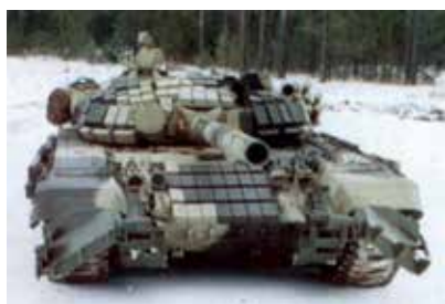
Figura N° 15: Tanque T-80 ruso, con placas de blindaje reactivo instaladas en la torre y el chasis.
